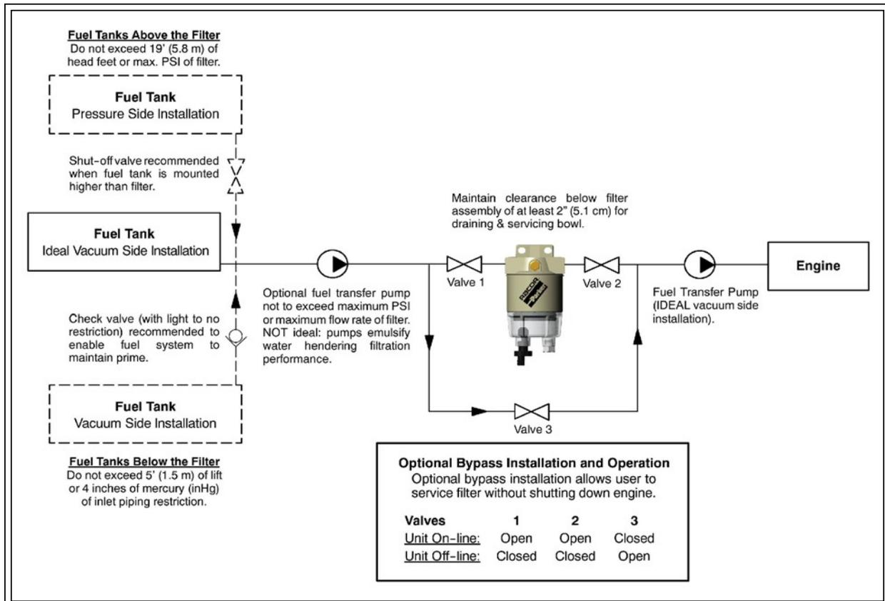
Das Installationsdiagramm gilt für alle 100er Serie Filter. Modell 120A siehe oben. Racor bietet Schlauch und Zusätze an, um die Installation vervollständigen zu können. Siehe Zubehör.
