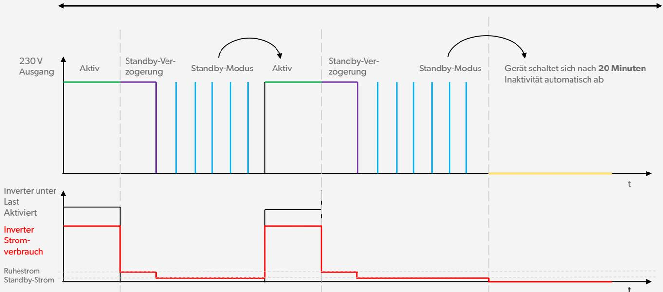
**AKTIVMODUS:** Der Wechselrichter erzeugt 230 V AC, um einen angeschlossenen Verbraucher zu versorgen. Er entnimmt der Batterie soviel DC-Strom wie es braucht, um den Energiebedarf des angeschlossenen Geräts zu sättigen.
