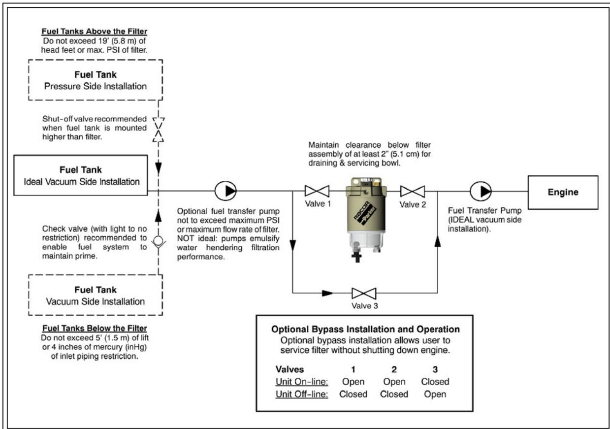
Das Installationsdiagramm gilt für alle 200 Serie Filter. Oben wird das Modell **215R** gezeigt. Racor bietet Schlauch und Zusätze an, um die Installation vervollständigen zu können. Siehe Zubehör.
