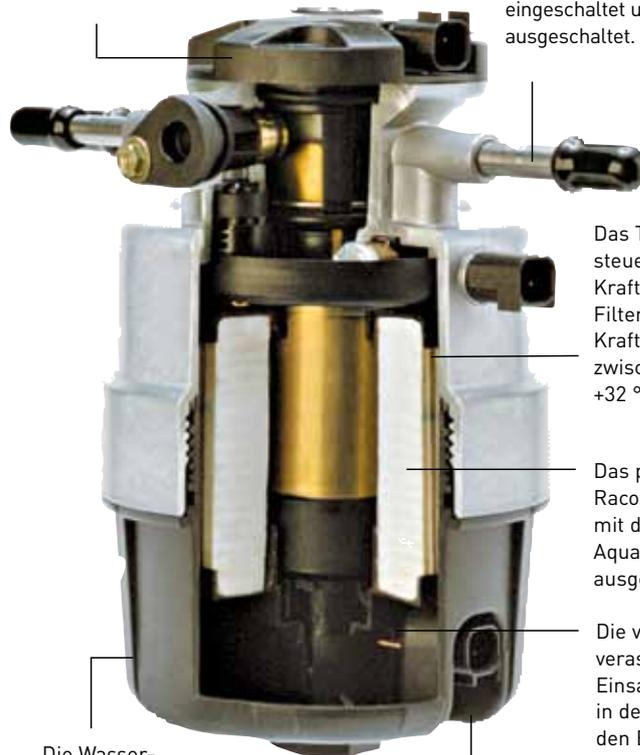
Das Thermostatventil steuert den Kraftstoffrücklauf vom Filter zum Tank um die Kraftstofftemperatur zwischen +10 und +32 °C zu regeln.
